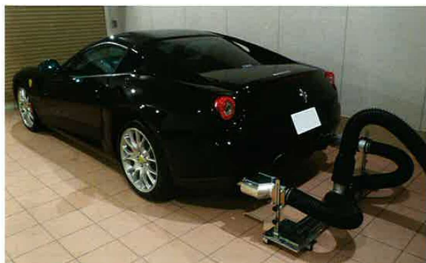
ガレージ内壁面に設置されるモーターは家庭用100V電源にて稼働。壁面にモーターを設置することで、非常に高い排気効率を実現している。オプションによりカラーリングやロゴを入れる変更が可能。
