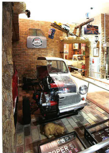
ミニの構造が分かるカットモデル。シンプルな構造でありながらも、マイナーチェンジを繰り返した歴史を積み重ねてきたミニが集約されている。
